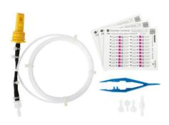
Ideal para monitorar a eficácia da lavagem de canulados em máquinas de reprocessamento automáticas de endoscópio e lavadoras ultrassônicas. Nível de desafio muito alto, dispositivo com 2 metros de mangueira e 2mm de diâmetro. A embalagem contém 1 dispositivo, 120 tiras indicadoras químicas adesivas, 1 pinça plástica e 1 adaptador para conexão de canulados.
