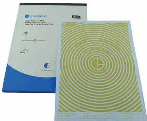
O teste Bowie & Dick foi desenvolvido para detecção de falha de funcionamento da bomba de vácuo dos esterilizadores a vapor.
